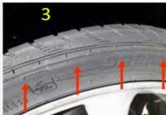
Zijwandbeschadiging door leeg berijden
