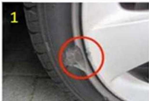
Beschadigd wiel en beschadiging in de zijwand
