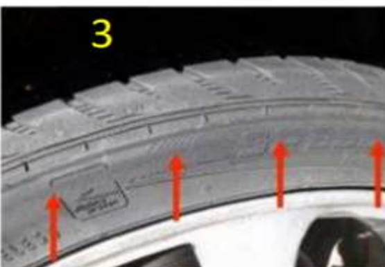
Zijwandbeschadiging door leeg berijden
