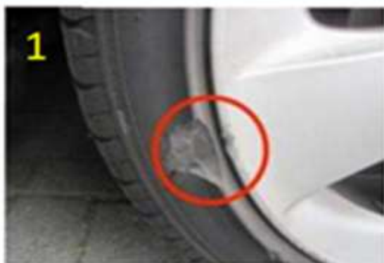
Beschadigd wiel en beschadiging in de zijwand
