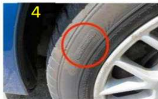
Foute montage (binnenzijde buiten gemonteerd)
